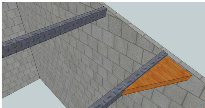
2) Si la panne du bas n'arrive pas jusqu'au mur, fixer un tasseau sur le mur dans l'alignement des pannes en le décalant de 4 cm vers le haut pour tenir compte de l'épaisseur du panneau Bespo
