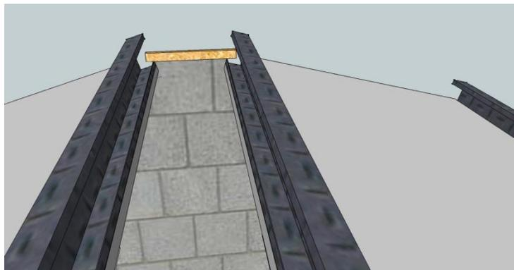
9) Positionner un morceau de fourrure de plaque de plâtre ou de liteau en appui sur les pannes C et dans l'encoche de l'élément de faîtage.
