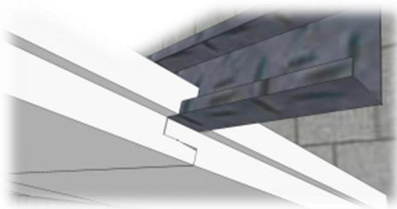
6) Emboiter l'arrière du 2<sup>ème</sup> panneau sur le premier et sur la panne C, appliquer la colle sur la languette puis positionner le panneau contre la panne C.
