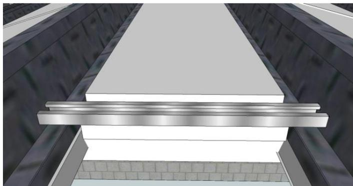
Déposer de la colle sur les parties emboîtées du panneau, puis maintenir le rail et le panneau avec des serre-joints. Visser le panneau dans la fourrure et dans le liteau fixé au mur.
