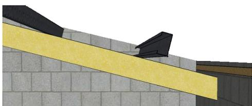
3) Tracer et découper, si besoin, le 1<sup>er</sup> panneau le long de chaque mur pour qu'il soit rigoureusement aligné avec la 1<sup>ère</sup> panne.
